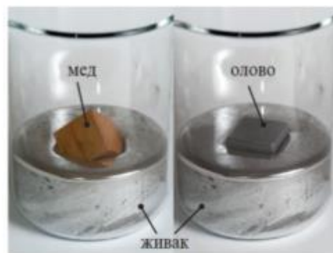
Фиг. 5. Защо потопената в живака част на медното кубче е по-малка от тази на оловното? Ще плават ли двете кубчета във вода?
